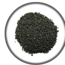
**Charbon vierge activé extrudé de 4mm à haute porosité. Spécialement conçu pour éliminer les COV.**
